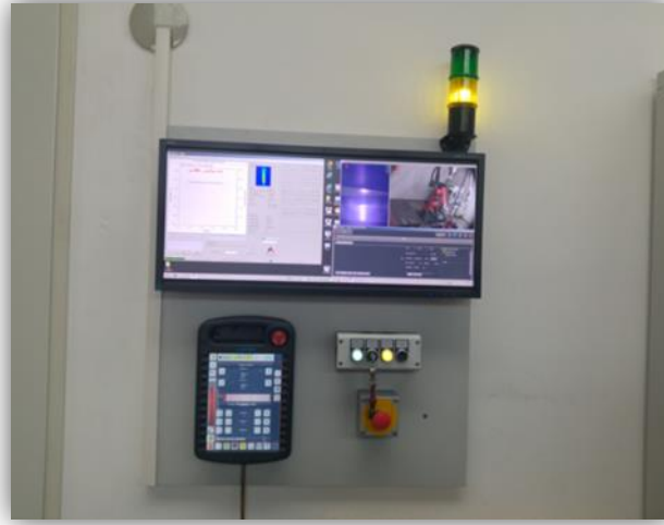
Şekil 7. Laser Yüzey Sertleştirme Yöntemlerinin Gerçekleştirdiği Kabinin Dıştan Bir Görüntüsü, Kumanda Kontrol Panosu.
