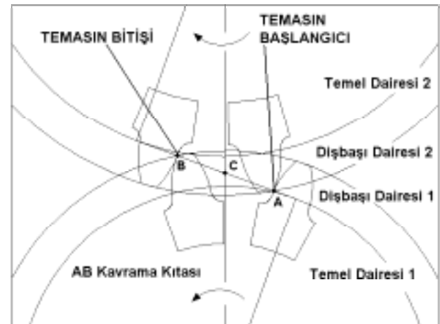
Şekil 2. Düz Dişli Çarklarda Kavrama Şeması
