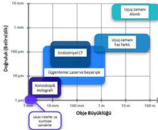
Şekil 16. Farklı dokunmasız yöntemlerin doğruluk açısından kıyaslanması [16]
