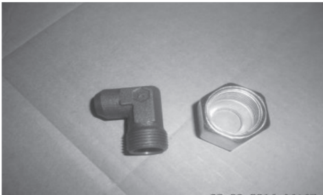
Şekil 14. Fosfat ve Asitli Çinko Kaplama
