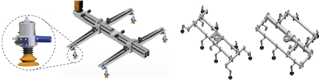
Şekil 15. Pres Beslemesi İçin Birden Fazla Taşıma Aparatı Yerine Kilitleme Sistemi ile Tek Aparat
