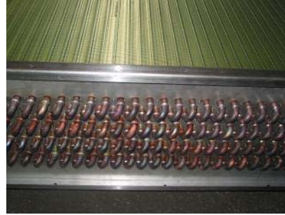
Şekil 14. Boru Şişirme Makinesi ile Bakır Boruların Şişirme işlemi ve Dirseklerin (Kurveller) görünümü [11]
