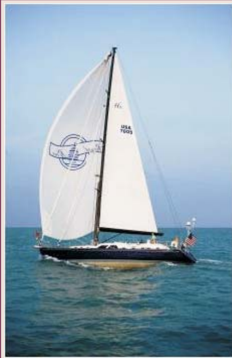
Şekil 1. Karbon Elyaf Kullanılan 29 Metrelik Gemi Direği, Standart Alüminyum Direğe Göre 318 kg Daha Hafif İmal Edilmiştir [GMT kompozit, ABD, 2011].
