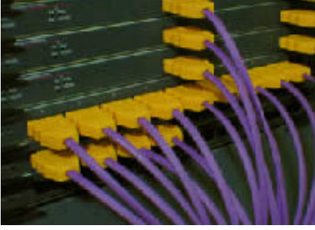
Şekil 10. Asahi Cam Firmasının İmalatı Dereceli İçeriğe Sahip Cytop TM Optik Tel [1] 4.5. Enerji Malzemeleri
