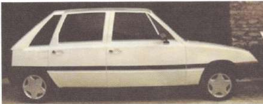
1979 yılında Amerika ve Avrupa'daki en son bulgularla yapılan Çağdaş, otomotiv sanayisinde fiberglas koltuğun kullanıldığı ilk örneklerden, Çağdaş, gövde panelleri ayrı ayrı, yapışma ve ekolojik araç olarak tasarlanmıştır. Motor olarak da lisansı alınmış TRM 102 Wankel motor kullanıldı. Birçok 'ilke' sahip olmasına rağmen Çağdaş üretilmedi.
