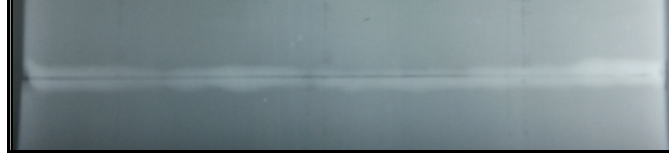
Şekil 7 Test Parçası Kaynağının Radyografik Muayene Film Görünümü
