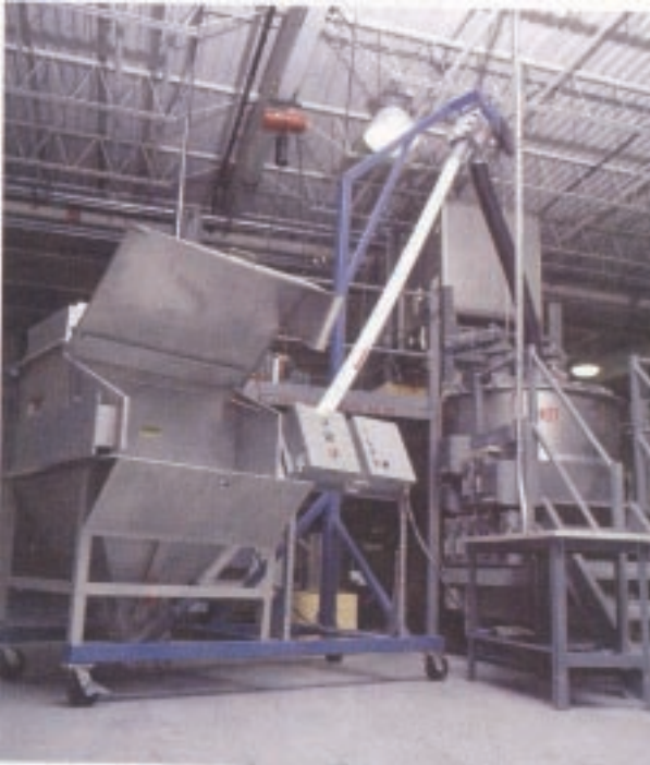
Füme silika boşaltma istasyonu, toz toplayıcı ve esnek vidalı taşıyıcı kendilerine yetmekte.
