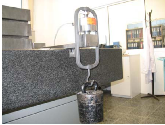
Şekil 3. 10 – 50 Kg Arası Yük Hücrelerinde Basma Yönü Kontrolü İçin Uygulama
