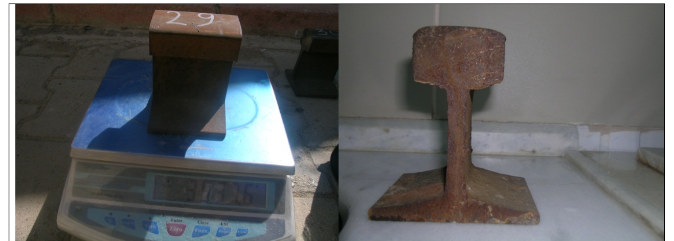
Resim 2. a) 10 cm'lik Ray Numune Ölçümleri b) Deforme Olmuş Ray
