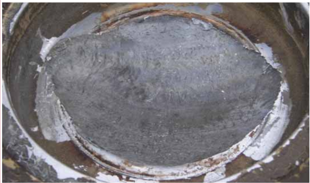
Şekil 7. Flanş Üzerinde Kırık Yüzeyin Makro Görüntüsü
