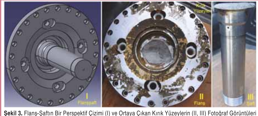
Şekil 3. Flanş-Şaftın Bir Perspektif Çizimi (I) ve Ortaya Çıkan Kırık Yüzeylerin (II, III) Fotoğraf Görüntüleri
