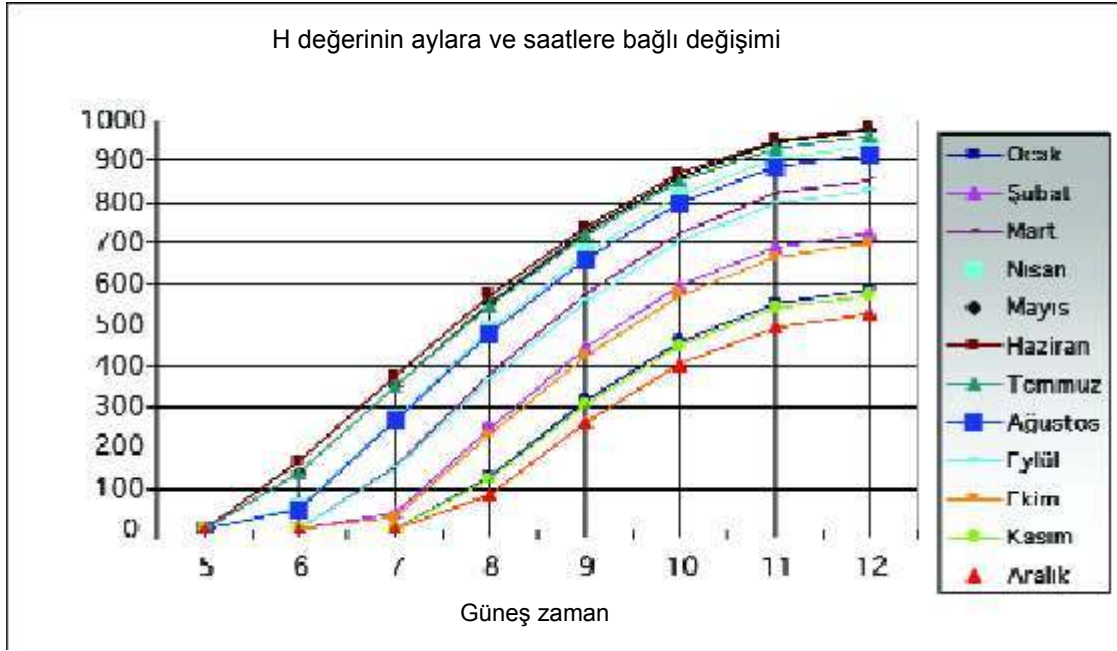
Şekil 7. H toplam ışınımının r_g = 0.2 için aylara ve saatlere bağlı olarak değişimi (Mersin ili)
