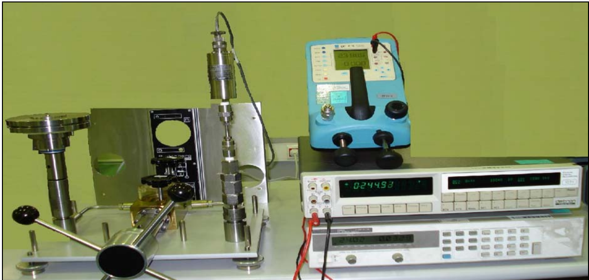
Şekil 2. Basınç Dönüştürücü Kalibrasyon Düzeneği
