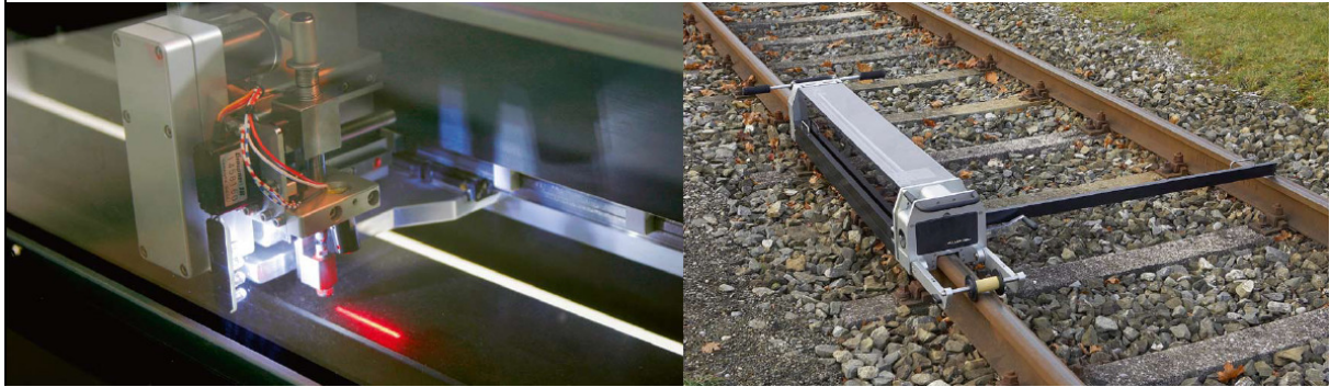
Şekil.10 Temaslı ray pürüzlülük ölçüm cihazı, Ölçüm hattını belli etmek için lazer pointer kullanılmaktadır [12].
