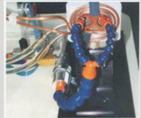
Model 3215 Vortex Tüpü, tıbbi tüp şekillendirme makinesi üzerinde kalıbı soğutur.
