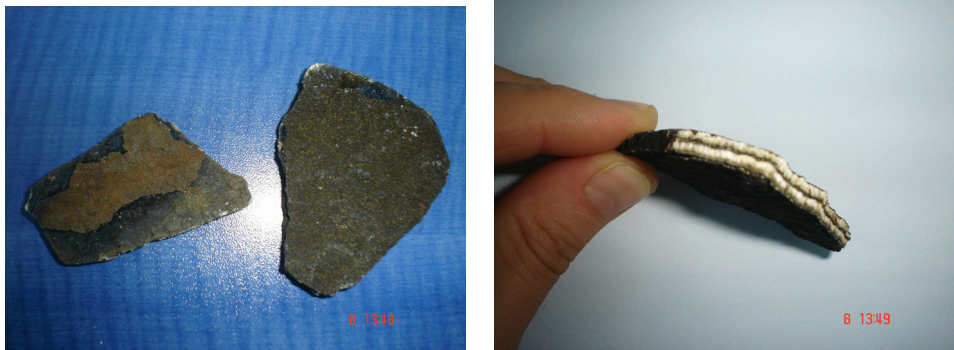
Şekil 14 Ana Gaz Seperatörü Tahliye Hattından Alınan Kabuk Örnekleri.
