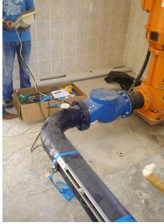
Şekil 8. Edremit JBIS'de Bulunan EDJ-2 Kuyu Başı Tesisatında Ultrasonik Debi Ölçüm Çalışması.
