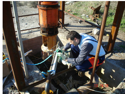
Şekil 9. Bigadiç JBIS'de Bulunan HK-6 Kuyu Başı Tesisatına Yapılan By-Pass Hattı ve Bu Hat Üzerinde Ultrasonik Debi Ölçüm Çalışması.
