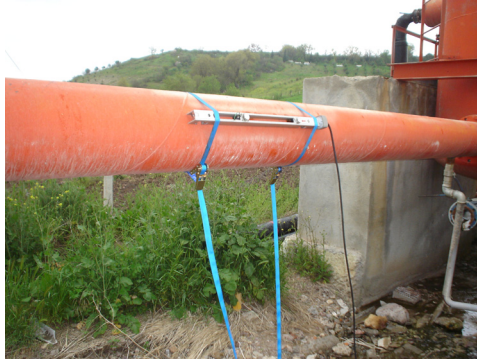
Şekil 13. Bigadiç JBIS'de Gaz Seperatöründen Sonraki Bir Noktada Ultrasonik Debi Ölçüm Çalışması.
