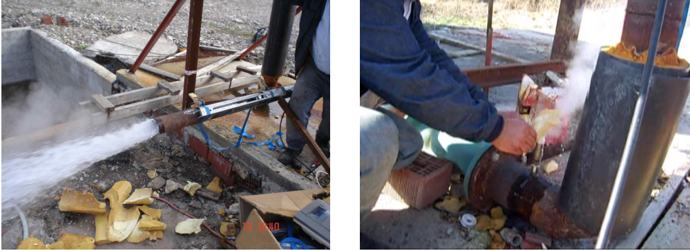
Şekil 12. Bigadiç JBIS'de Bulunan HK-8 Kuyusundan Elde Edilen Jeotermal Akışkanda Görülen Yoğun Buhar.
