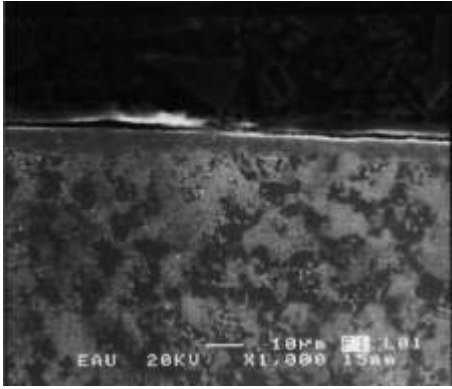
Şekil 3. Nitrürlenmiş Malzeme (AISI 5140) Nitrürlü Tabakanın SEM Görünüşü, T = 450\text{ }^{\circ}\text{C} , t = 4\text{ saat} [13]
