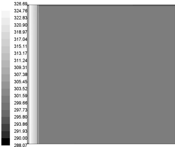
e) Oda sıcaklık dağılımı (G.A.=400 W/m 2 )
