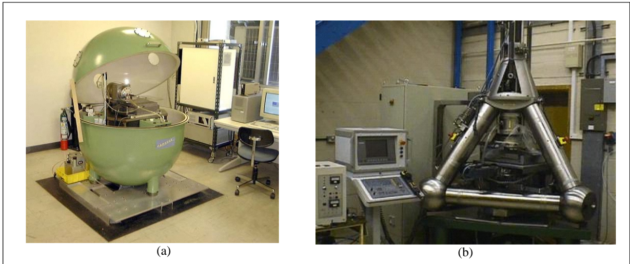
Şekil 2 a) Ito vd. Tarafından Geliştirilen Yüksek Hassasiyette Elmas Takımlı Torna Tezgahı "Capsule". [8] b) Cranfield Üniversitesi'nde Geliştirilen "Tetraform C" [9]
