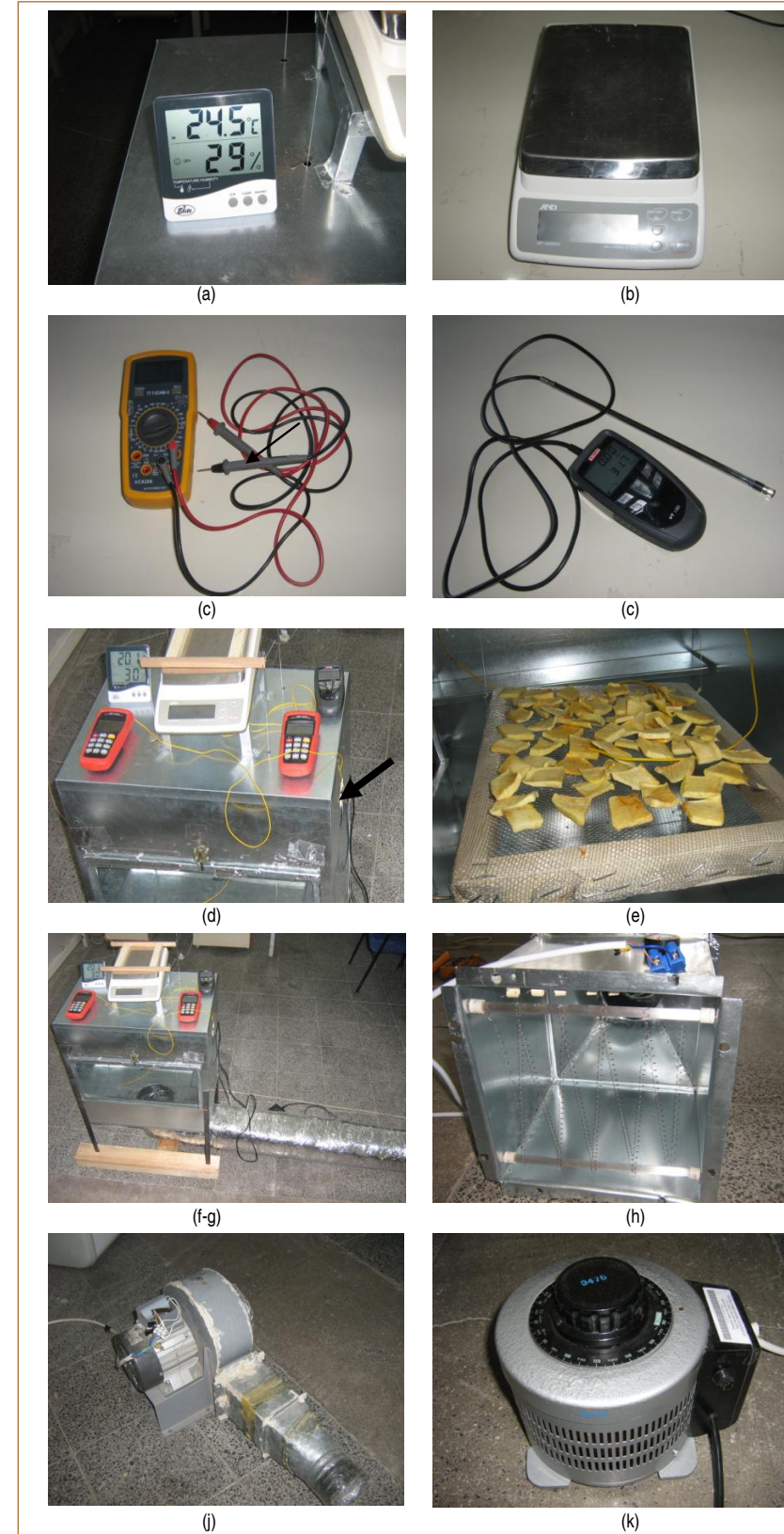
Şekil 2. Deney Düzeneğini Oluşturan Ana Elemanlar; a. Nemölçer, b. Dijital Terazi, c. Voltmetre ve Anemometre, d. Hava Çıkış Kanalı, e. Kurutma Tepsisi, f. Kurutma Kabini, g. Hava Akış Kanalı, h. Isıtma Sistemi, i. Fan, k. Varyak
