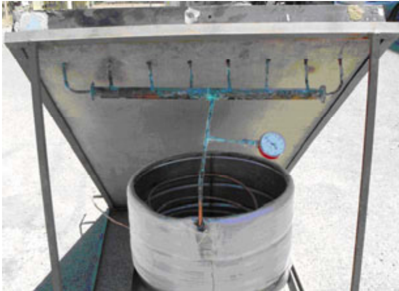
Şekil 2. Güneş Kolektörü ile Sıcak Su Deposu Bağlantısı.
